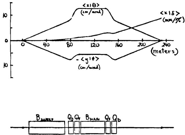
$$B_{\text{SWEEP}} \quad 15 \text{ kG} \times 60 \text{ m} \Rightarrow 1.8 \text{ mrad bend}$$
