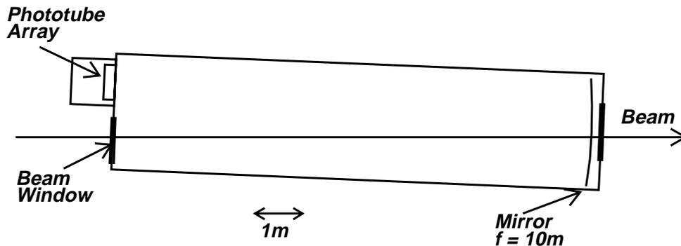
Fig. 1. Vessel Layout.
