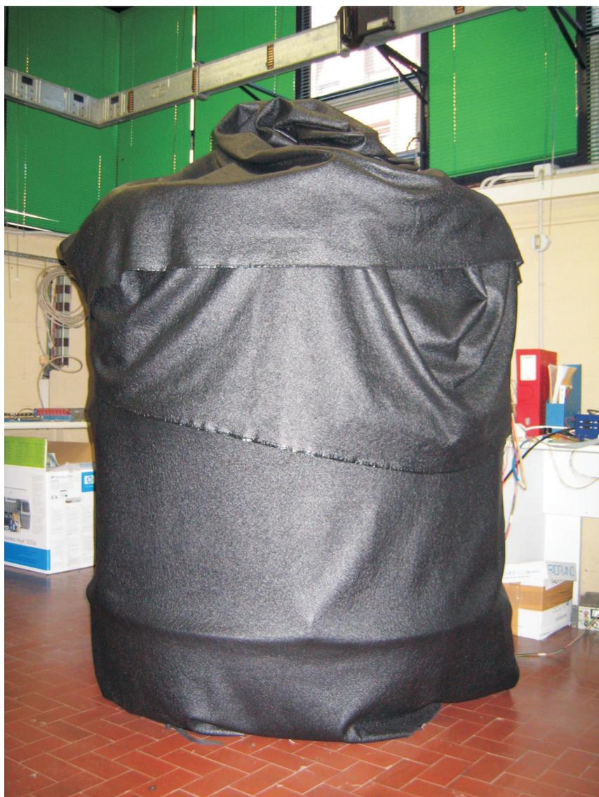
Figura 4.2: Con l'ausilio di un panno nero plastificato, si riduce fortemente il rumore ottico rilevato dalla strumentazione di misura del *biofouling*.
