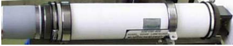
Figura 3.7: Modem acustico sottomarino ATM-877 Datasonic.
