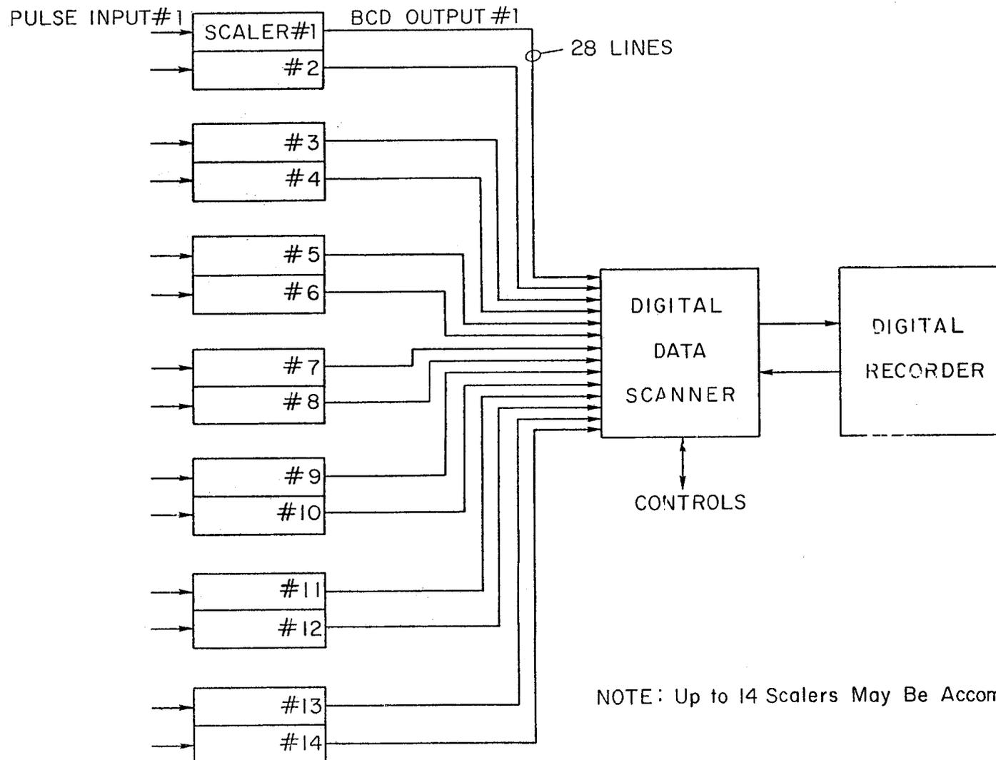
Fig.1 SCALER PRINTOUT SYSTEM-BLOCK DIAGRAM
