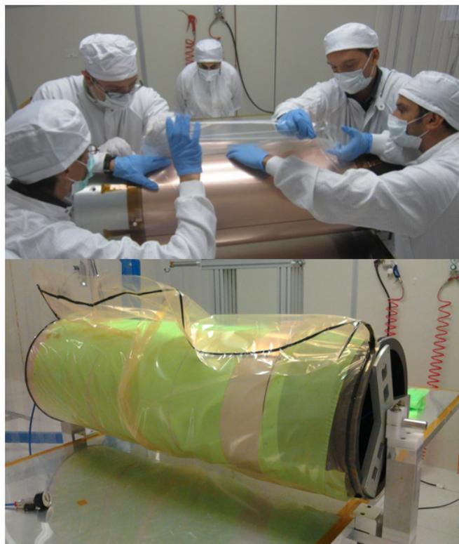
**Figura 3.28:** Fasi salienti dell'incollaggio cilindrico: in alto, il foglio GEM di grandi dimensioni viene adagiato sul mandrino. In basso, dopo aver effettuato l'incollaggio cilindrico, l'elettrodo viene circondato da tessuto traspirante (in verde) e racchiuso in una vacuum bag per praticare il vuoto.
