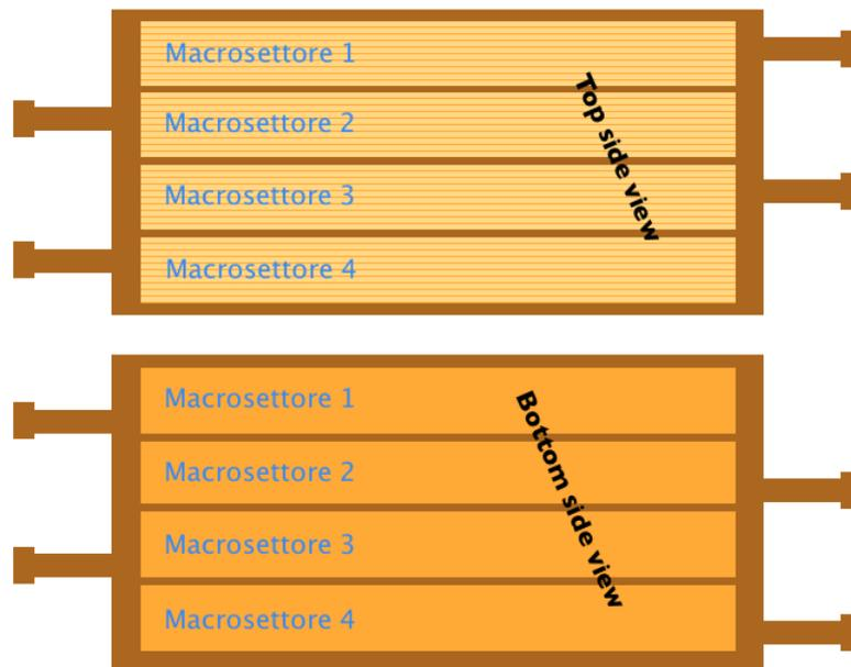
**Figura 3.34:** In alto, schema della segmentazione in macrosettori e microsettori del lato top di un foglio GEM. In basso, schema della segmentazione in macrosettori del lato bottom di un foglio GEM.
