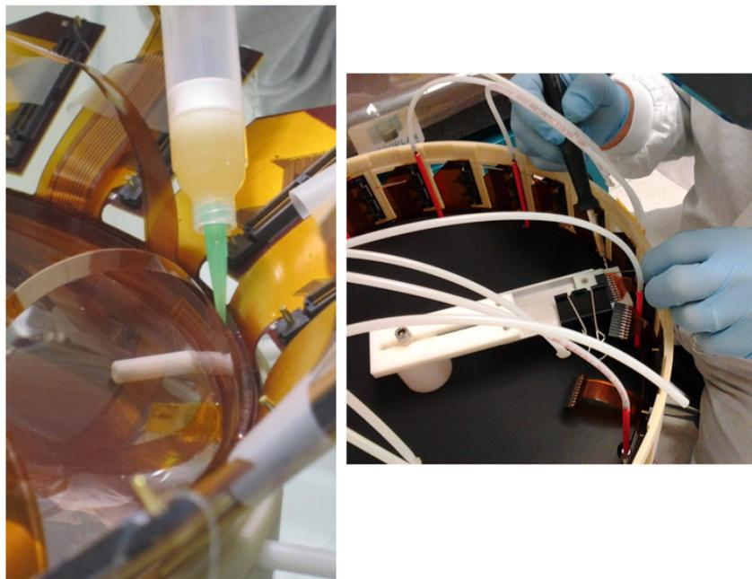
**Figura 3.31:** A sinistra, applicazione di Araldite per la sigillatura del Layer3. A destra, saldatura dei connettori HV alle codine di Kapton.
