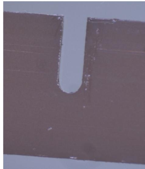
**Figura 3.39:** Ispezione al microscopio di un componente di una griglia di PEEK del Layer4: nella foto a sinistra sono evidenti eccessi di materiale all'interno della scanalatura; nella fotografia a destra, invece, è possibile vedere il risultato finale, dopo la rimozione del PEEK in eccesso.
