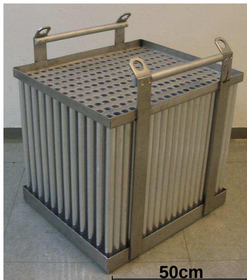
Abbildung 3.4: Fotografie eines Kühlelements. Zu sehen sind die 240 Rohre, die von einem Rahmen zusammengehalten werden. Die Griffe und Ösen dienen dem Transport.
