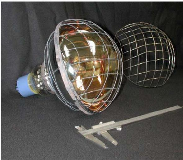
**Figura 21 - PMT con schermo magnetico.**
