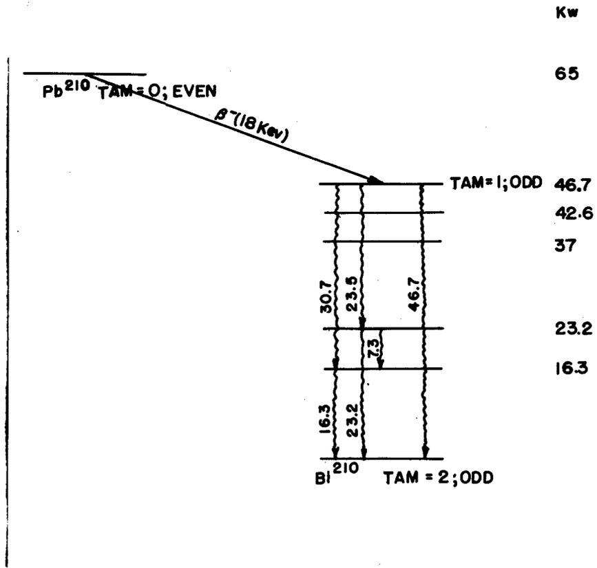
Fig. 11. Decay scheme of  $Pb^{210}$ .
