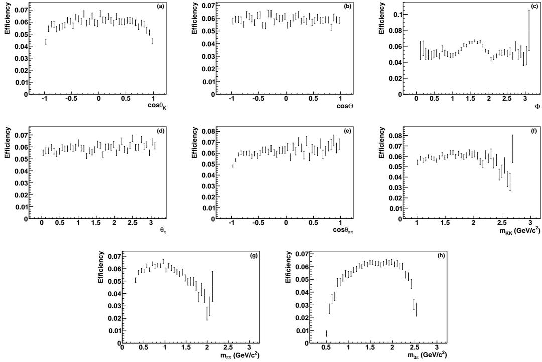
Figure 4.34: 1D projections of  $\gamma\gamma\rightarrow\eta_c(2S)\rightarrow K^+K^-\pi^+\pi^-\pi^0$  efficiency on (a)  $\cos\theta_K$ , (b)  $\cos\Theta$ , (c)  $\Phi$ , (d)  $\theta_\pi$ , (e)  $\cos\theta_{\pi\pi}$ , (f)  $m_{KK}$ , (g)  $m_{\pi\pi}$ , and (h)  $m_{3\pi}$ .
