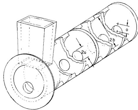
Fig. 2 - The « $TM_{01}$ -type» deflecting structure (LOLITA).
