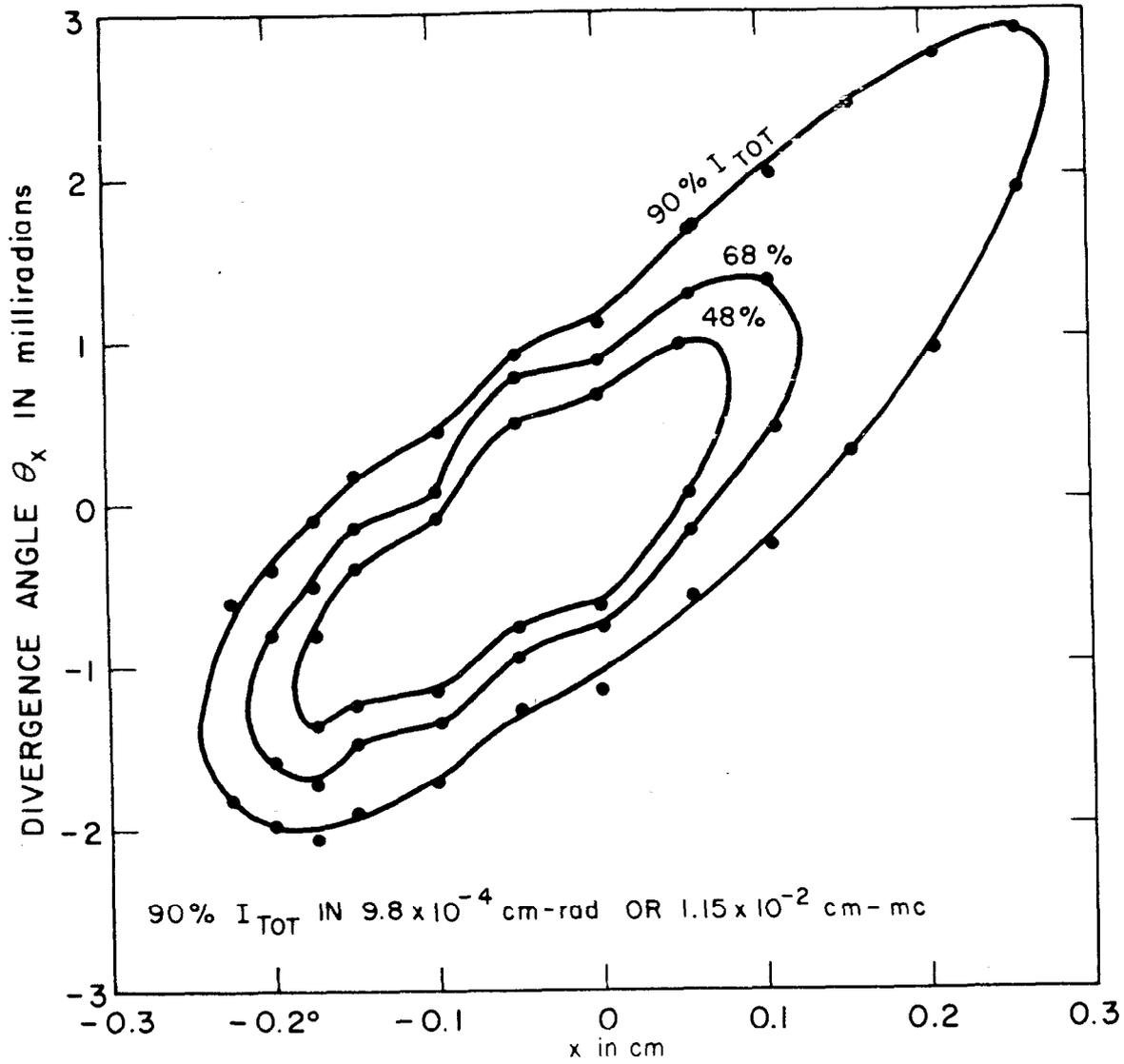
FIG. 4 TEST INJECTOR BEAM OPTICS
