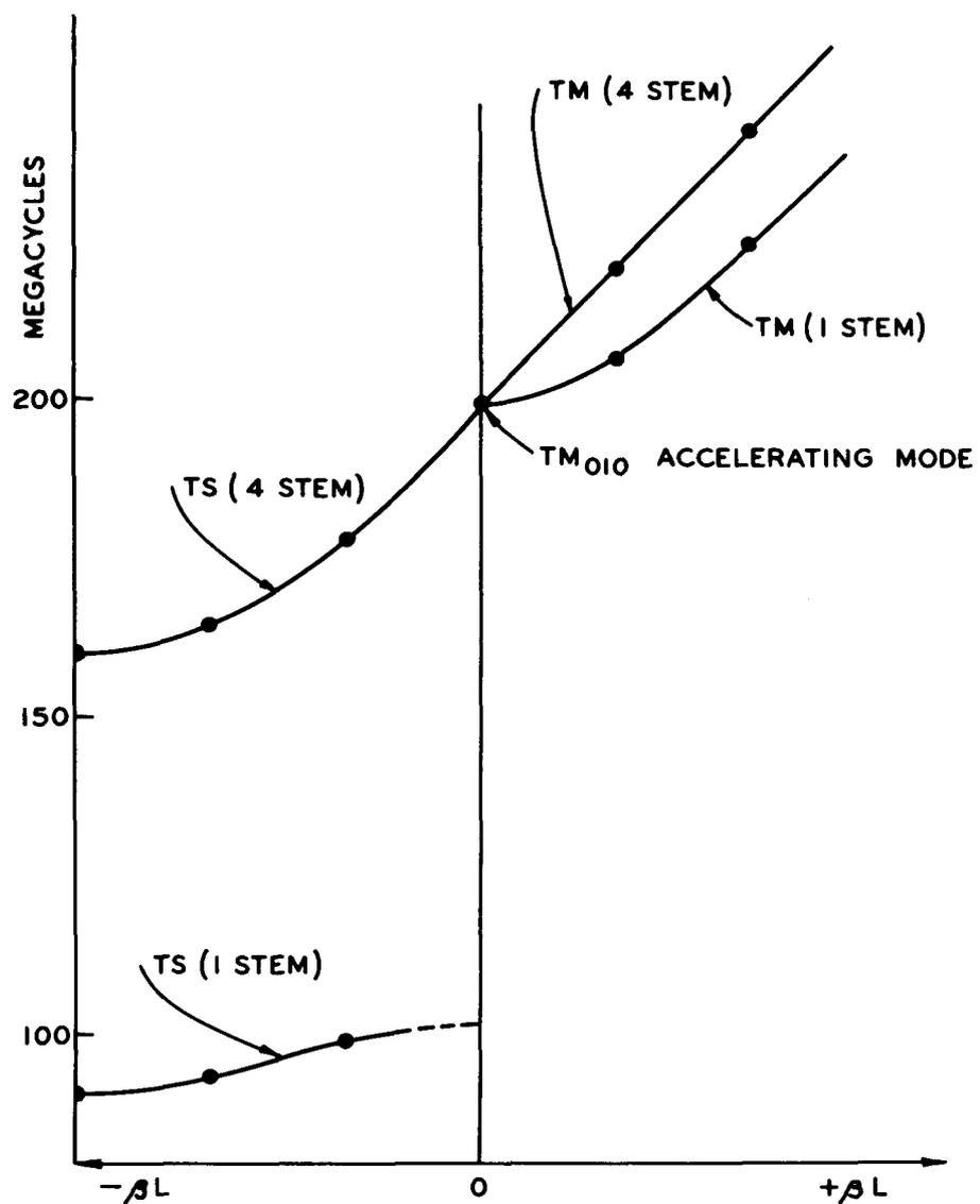
DISPERSION CURVE FOR MULTISTEM DRIFT TUBES
